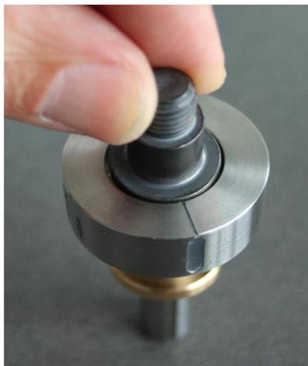
ねじ頭部をカバーするチューリップ型プローブ
