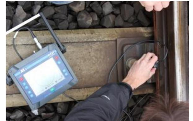
最適化された特製プローブ形状によりトンブレール切り欠き端部を正確に検査することが可能である。
