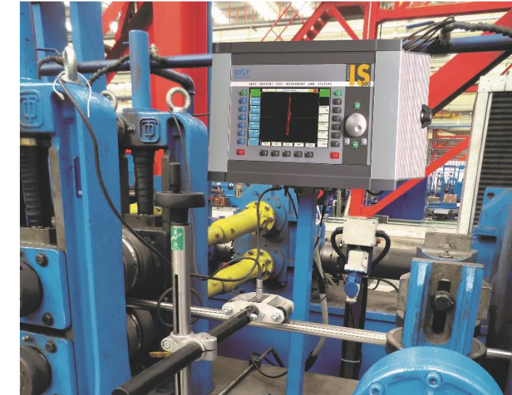
鋼管溶接シーム検査
